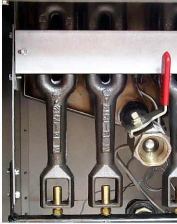
Tipik kızartma kabı boşaltma kabı vanası (gösterilen SM40)
